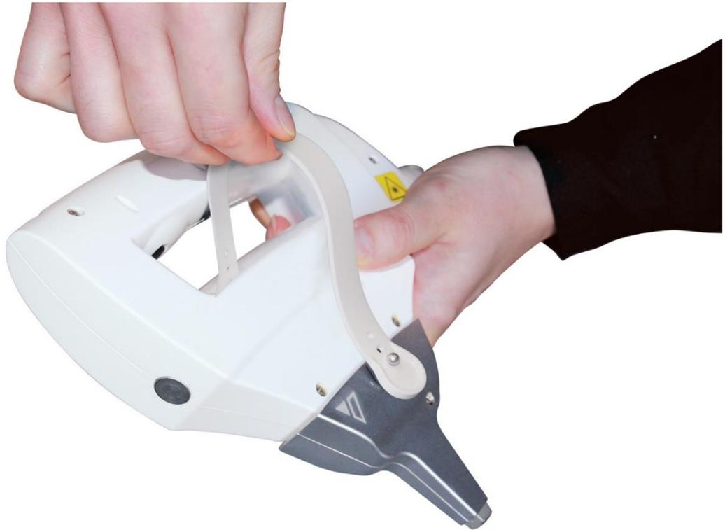
4. Spannen Sie das Band leicht und setzen Sie es an der zweiten Lasche ein.
